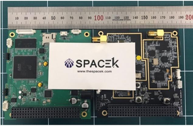
Fig. 1. 스페이스케이에서 개발 중인 품목(OBC, CS). OBC, On Board Computer; CS, Communication Systems.
